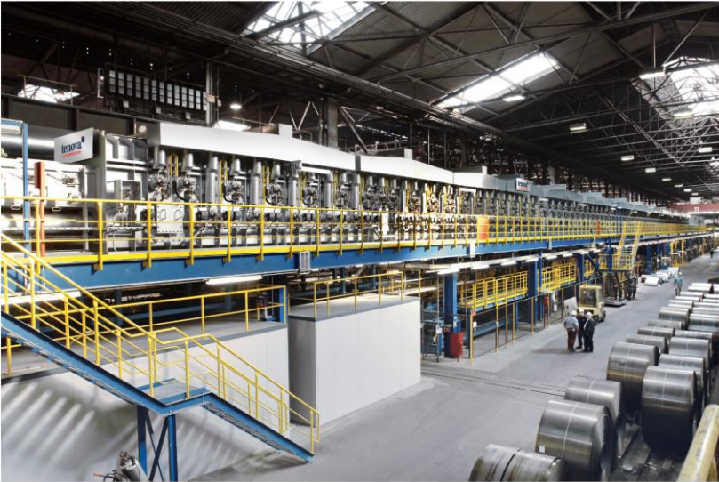
Bild Tenova LOI Thermprocess: Entkohlungs- und Beschichtungslinie (DCL-Linie).
